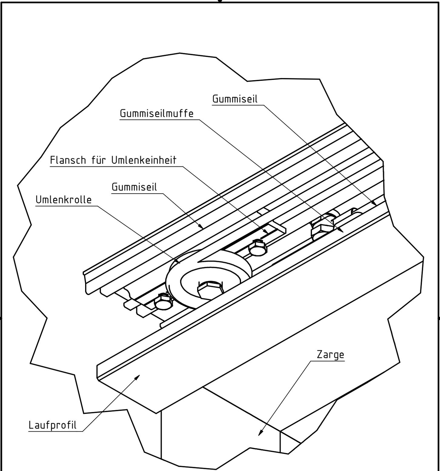
Die Zeichnung zeigt die linke Laufprofilseite, einer nach links schließenden Tür
