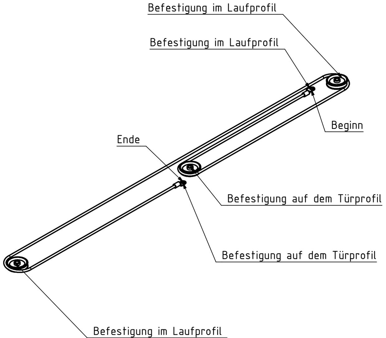
Die Zeichnung zeigt den Verlauf des Gummiseils bei einer nach rechts schließenden Tür.
